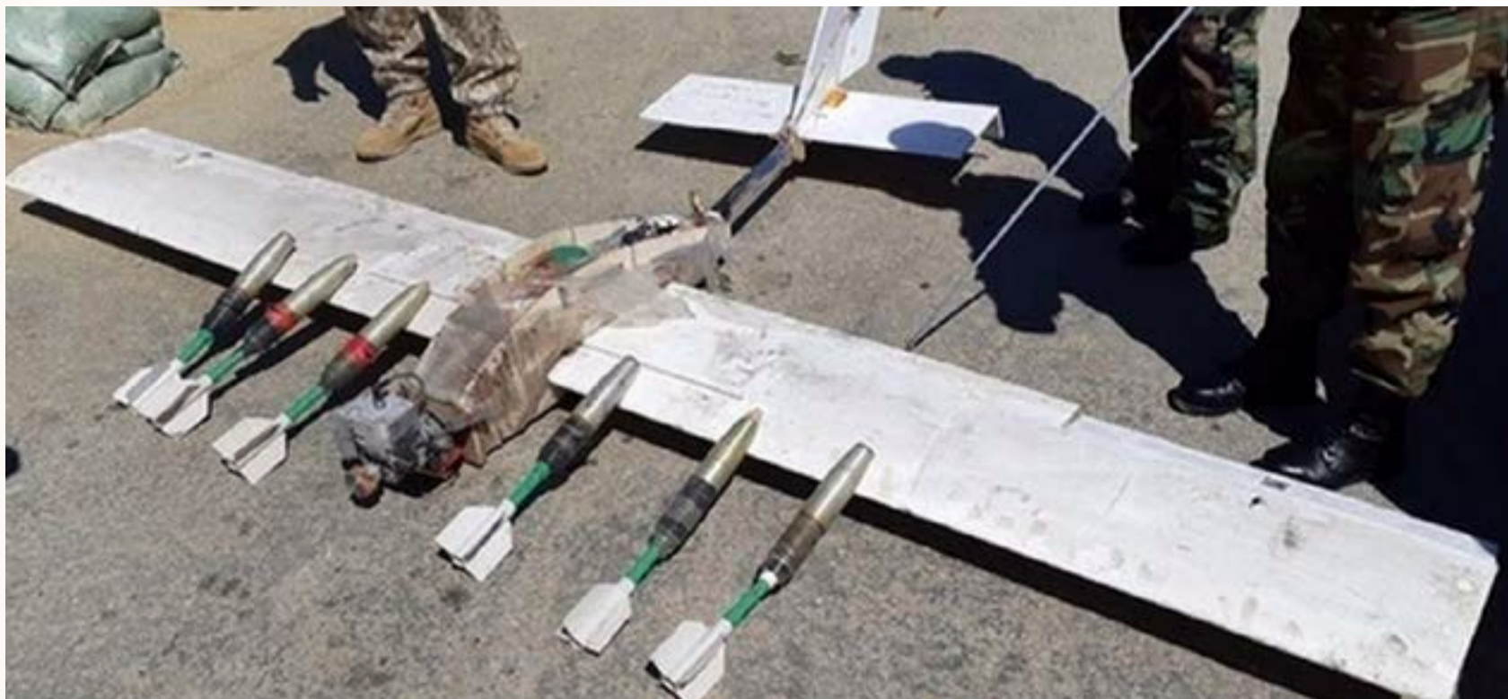
Рис. 5. Ударный беспилотник боевиков кустарного производства
