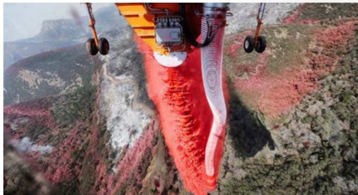
Огнезадерживающие полосы из ретардантов вокруг пожара, созданные вертолетами. Вид с борта пожарного вертолета. US Forest Service.
