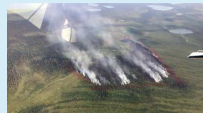
Ограничение распространения лесного пожара путем создания противопожарных барьеров из ретардантов. Вид с борта самолета Bird-dog. Провинция Онтарио, Канада.
