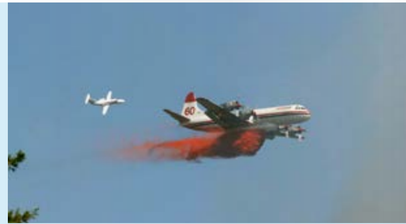
Наведение танкера экипажем Bird-dog на реактивном самолете Cessna Citation
