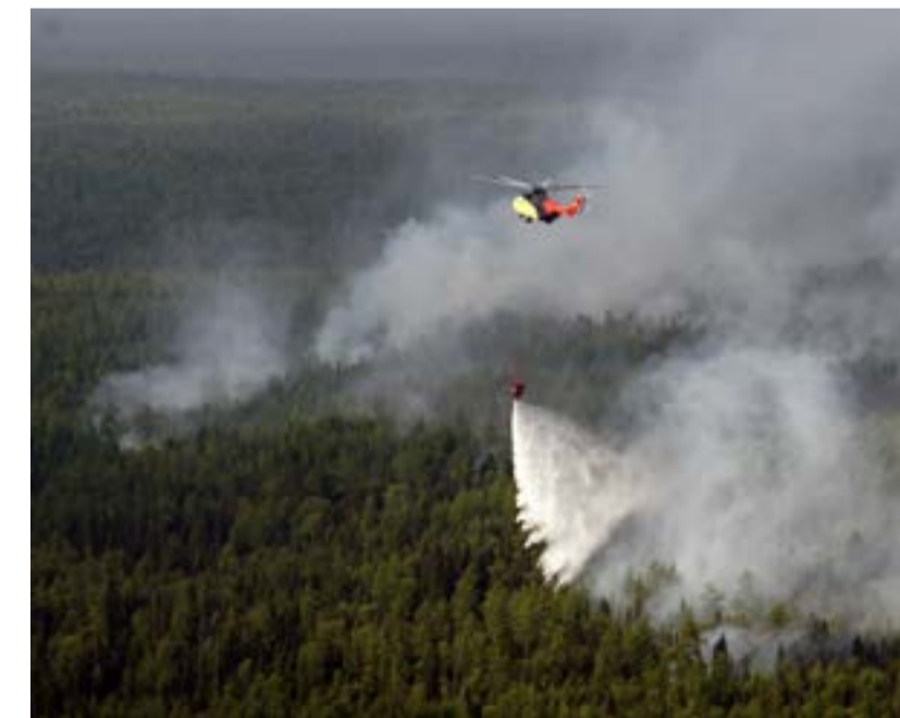
В 2012 г. Ханты-Мансийская база авиационной и наземной охраны лесов успешно применила 5 вертолетов Ми-26 с ВСУ-15. Общий налет 485 ч.
