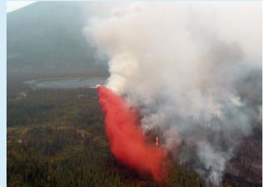
По возможности, в воду добавляют красители, чтобы были видны результаты атаки экипажам следующих танкеров. Канада.
