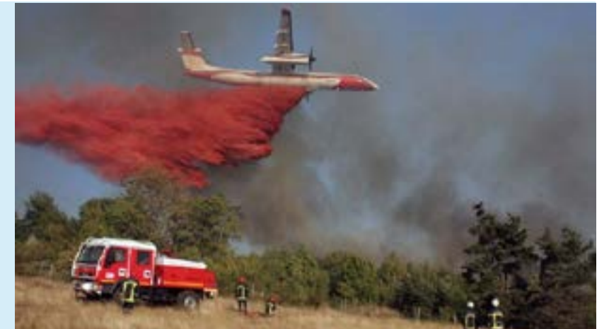
Самолет-танкер на базе пассажирского Dash 8-Q400MR. Securite Civile, Франция.
