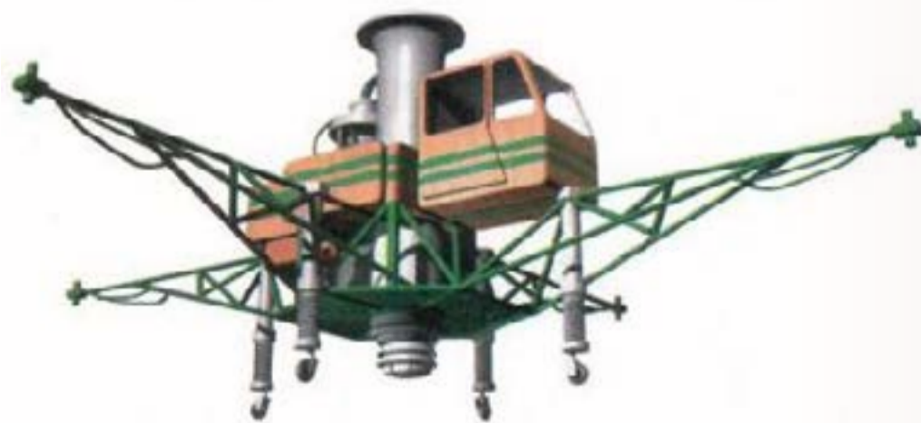
Рис. 3. Вертикально взлетающий «Турболет» в Тушине и динамический стенд-тренажер разработки ЛИИ на базе турболета
