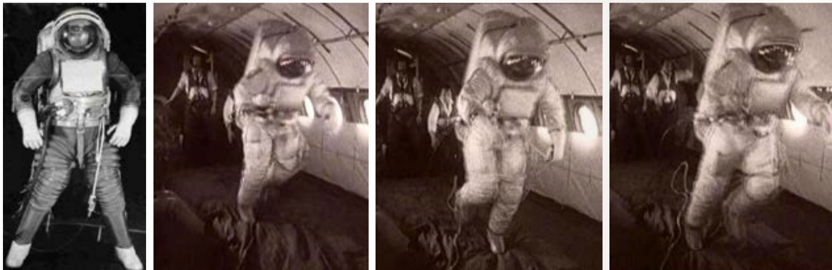
Рис. 9. Отработка устойчивой позы и бега при десантировании на поверхность Луны в скафандре «Кречет-94» на Ту-104А в условиях моделирования гипогравитации 1/6g при полете по параболической траектории Кеплера
