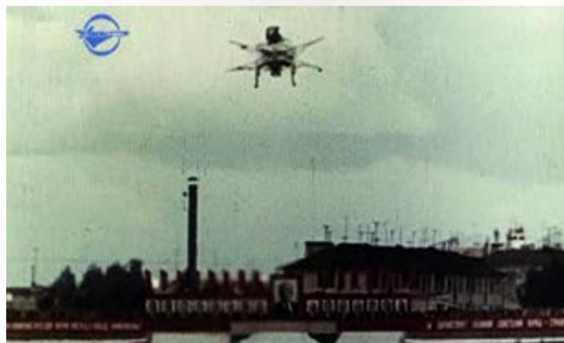
Рис. 3. Вертикально взлетающий «Турболет» в Тушине и динамический стенд-тренажер разработки ЛИИ на базе турболета
