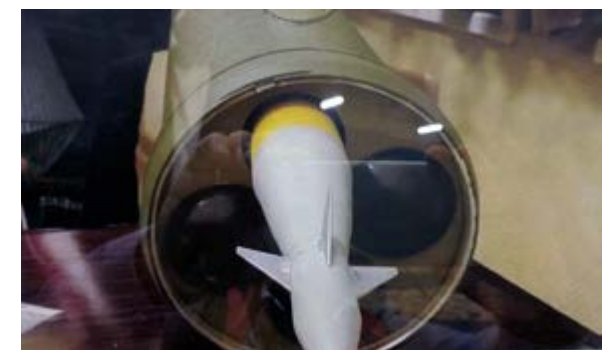
Пакет из четырех малогабаритных ЗУР в контейнере штатной ПУ ЗРПК «Панцирь-С»
