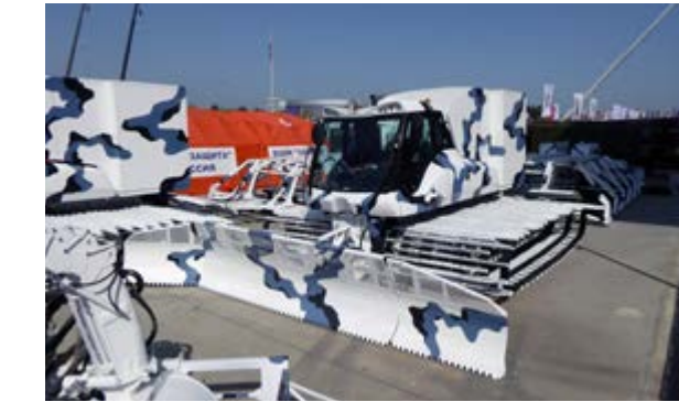
Машина для строительства ВПП в условиях Арктики
