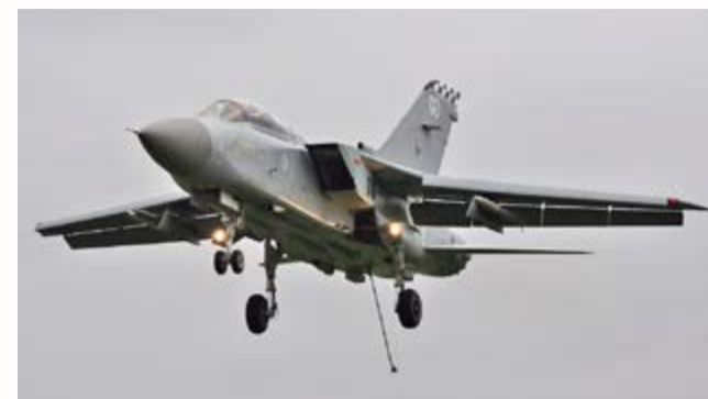
Рис. 11. Самолет «Торнадо» с крюком Шеффера
