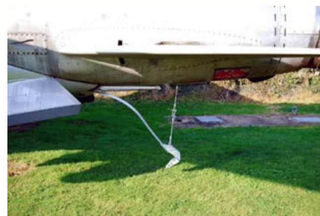
Рис. 7. Тормозный крюк Шеффера на Lightning F.6 ВВС Англии
