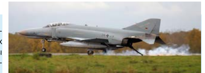
Рис. 9. Посадка истребителя F-4G с помощью тормозного крюка
