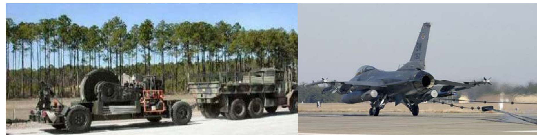
Рис. 1. Транспортировка мобильной тормозной машины ВАК-12
