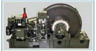
Рис. 14.2. Тормозная машина ВАК-12/500S с компьютерным управлением, входящая в состав тормозной системы SMARTARREST
