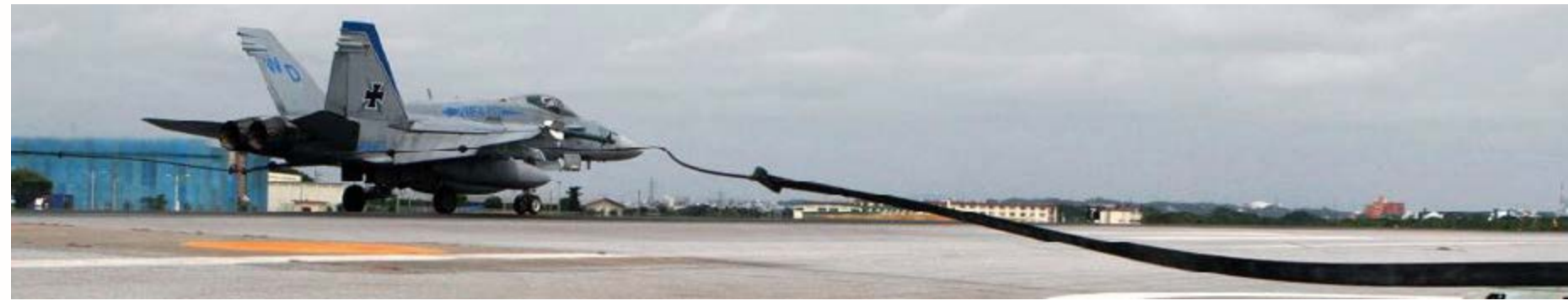
Рис. 3. Торможение истребителя F-18C ВВС (США) системой MAAS
