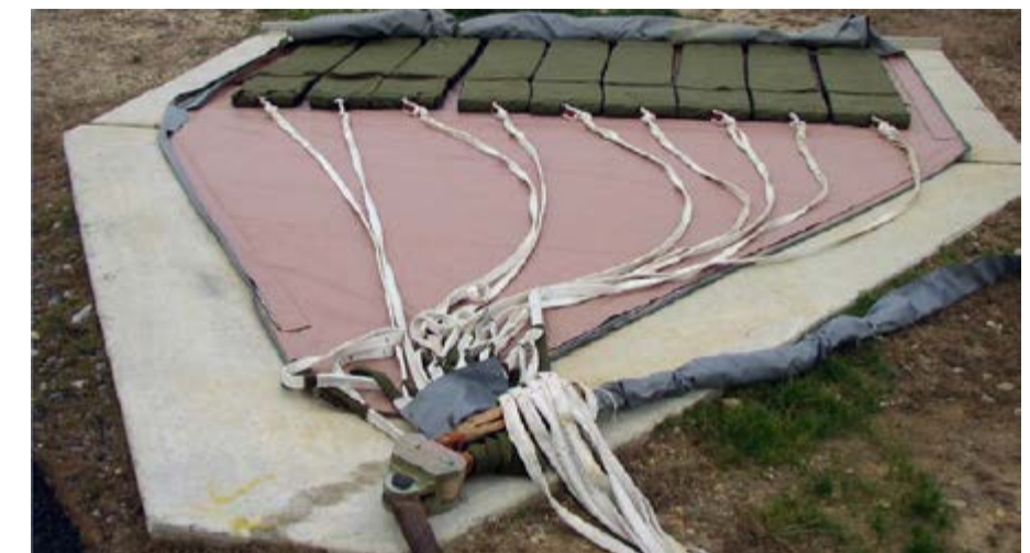
Рис.19. Модуль нейлоновых строп «текстильного» тормоза MB.60.9.9.
