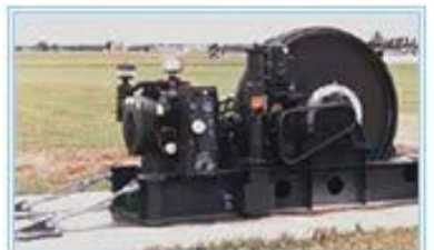
Рис. 14.1. Стандартная аэродромная тормозная машина ВАК-12/500S
