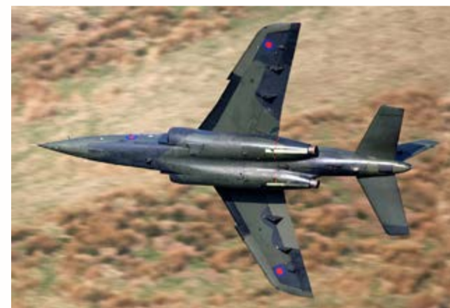
Рис. 13. Учебно-тренировочный самолет Alpha Jet с крюком Шеффера.
