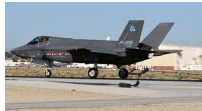
Рис. 4. Тормозный крюк истребителя F-35A для системы MAAS
