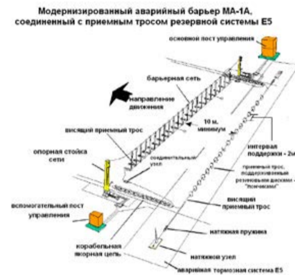
Рис. 12. Модифицированный аварийный барьер МА-1А/Е5
