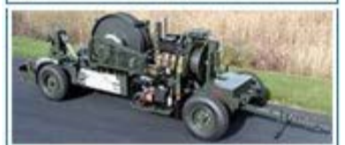
Рис. 14.3. Мобильная тормозная машина ВАК-12/500S, входящая в состав тормозной системы Portarrest P-IV
