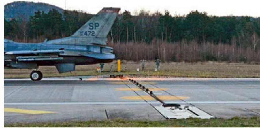
Рис.17. Незацеп троса крюком Шеффера на F-16
