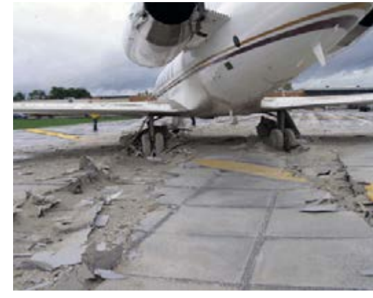
Рис. 21. Аварийное торможение на концевой полосе безопасности EMASMAX
