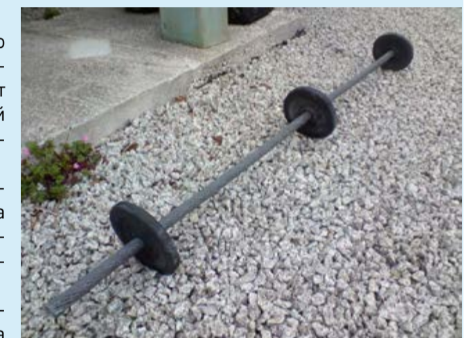
Рис. 10. Фрагмент приемного троса с резиновыми дисками-«пончиками»
