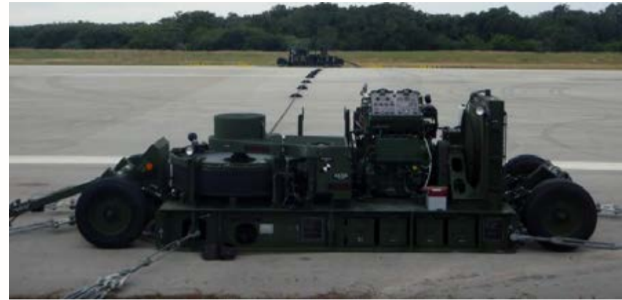
Рис. 20. Система укороченной посадки MC-31 на основе мобильной тормозной машины ВАК-13, адаптированной для нужд Корпуса морской пехоты
