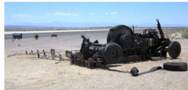
Рис. 5. Тормозная машина ВАК-12 подготовлена к сборке на базе Edwards
