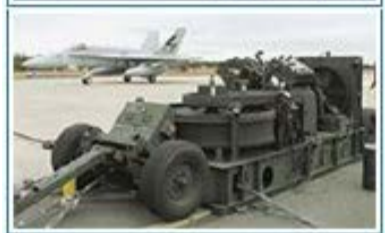
Рис. 14.4. Мобильная тормозная машина ВАК-13 с энергопоглотителем типа 34/44В, входящая в состав тормозной системы MC-31 Корпуса морской пехоты
