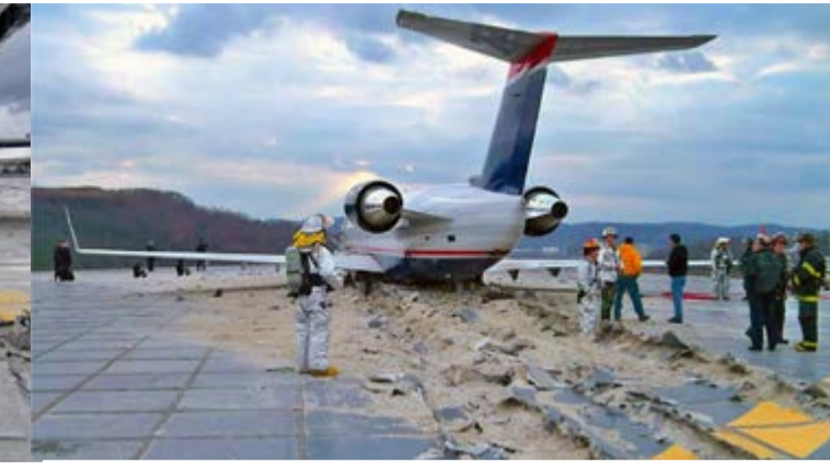
Рис. 22. Аварийное торможение самолета Bombardier-2000 с помощью EMASMAX
