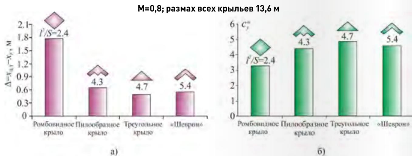
Рис. 4. Аэродинамические характеристики крыльев различных форм в плане: а – запас устойчивости; б – несущие свойства;  $l$  – размах,  $S$  – площадь
