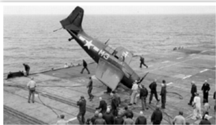
Рис.16. «Stinger» не помог – F4F остановлен аварийным барьером
