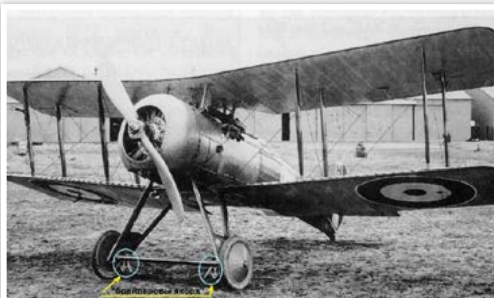
Рис.5 (б). Британский Gloster Nightjar с «брайлеровыми якорями»
