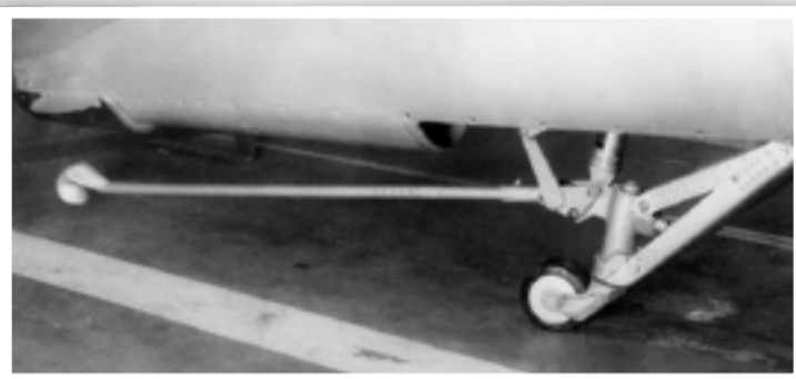
Рис.20. Крепление узла гака F4U Corsair
